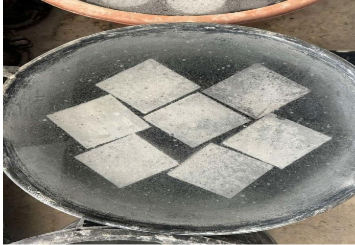
Figure II. 18 : Conservation des éprouvettes.
