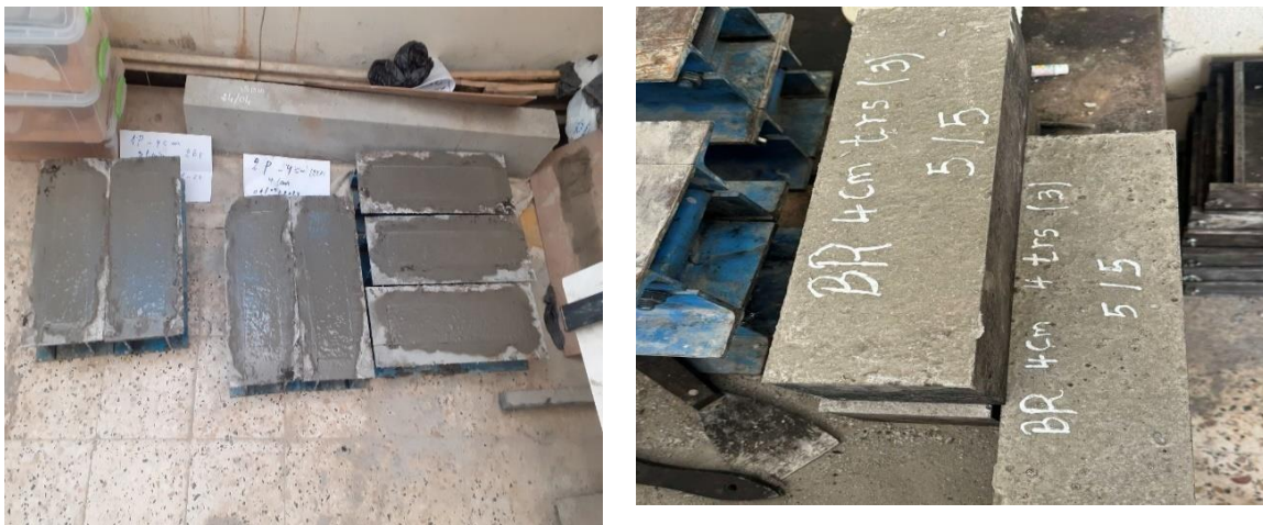
Figure II. 17: Séchage et désignation des éprouvettes.
