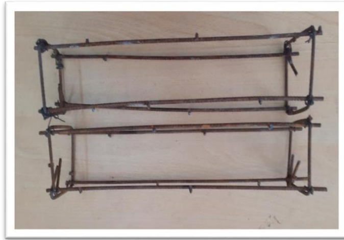
Figure II. 10 : Ferrailage des poutres.
