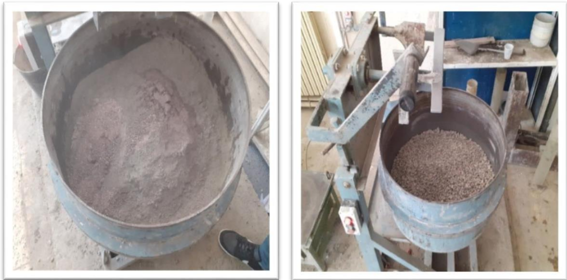
Figure II. 13 : Malaxage des différents composants du béton.
