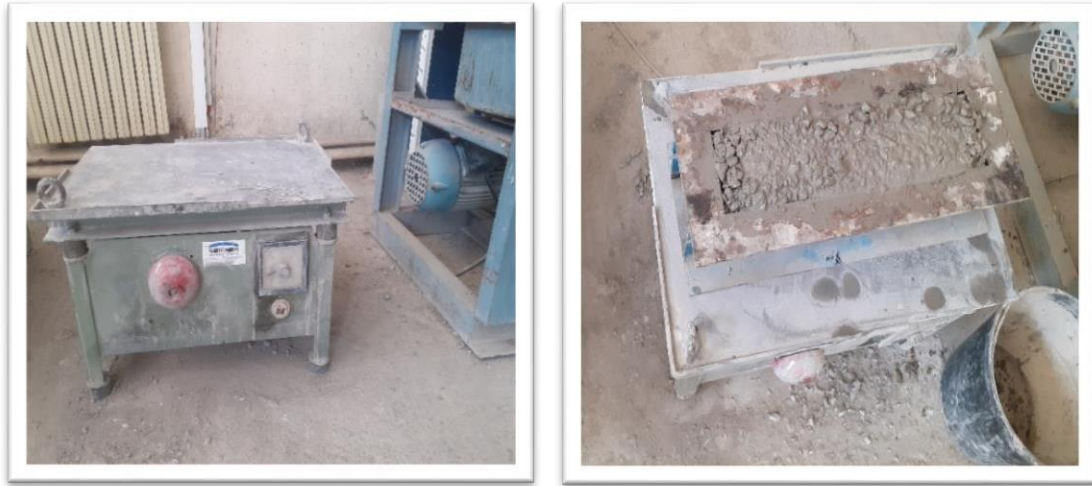
Figure II. 16 : Vibration du béton.
