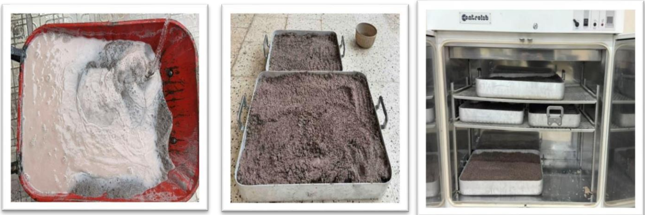
Figure II. 4: Processus de lavage et séchage du sable
