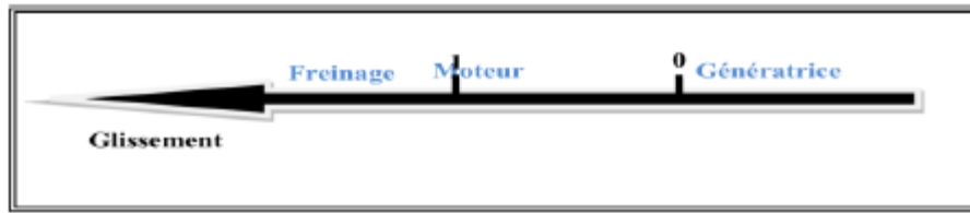
Fig. (I.1) : Modes de fonctionnement suivant le glissement.
