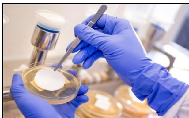
Figure 12 : Contrôle microbiologique de l'eau par la méthode de filtration sur membrane.
