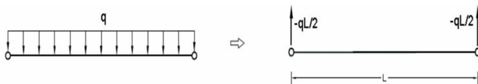
Fig. 2.14 : Cas du poids propre d'une barre d'un treillis.
