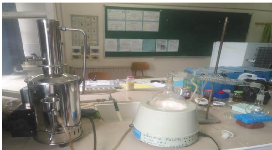
Figure 24 : Appareil d'hydro-distillation de type Clevenger. (Originale, 2022)
