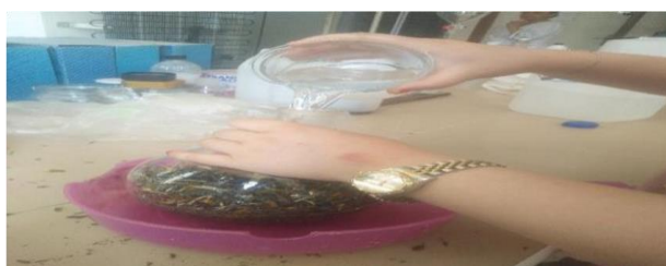
verser 1l d'eau distillée et le végétal dans le ballon
