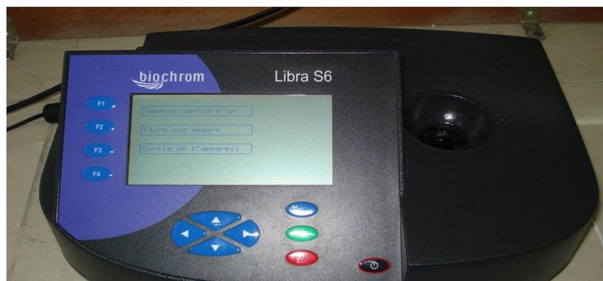
Figure N°14 : spectrophotomètre UV-Visible.
