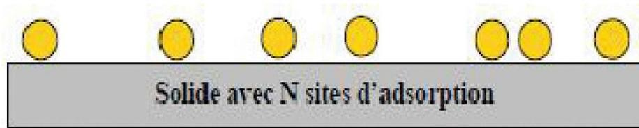
Figure N° 08 : Isotherme et Modélisation de l'adsorption selon Langmuir [56]
