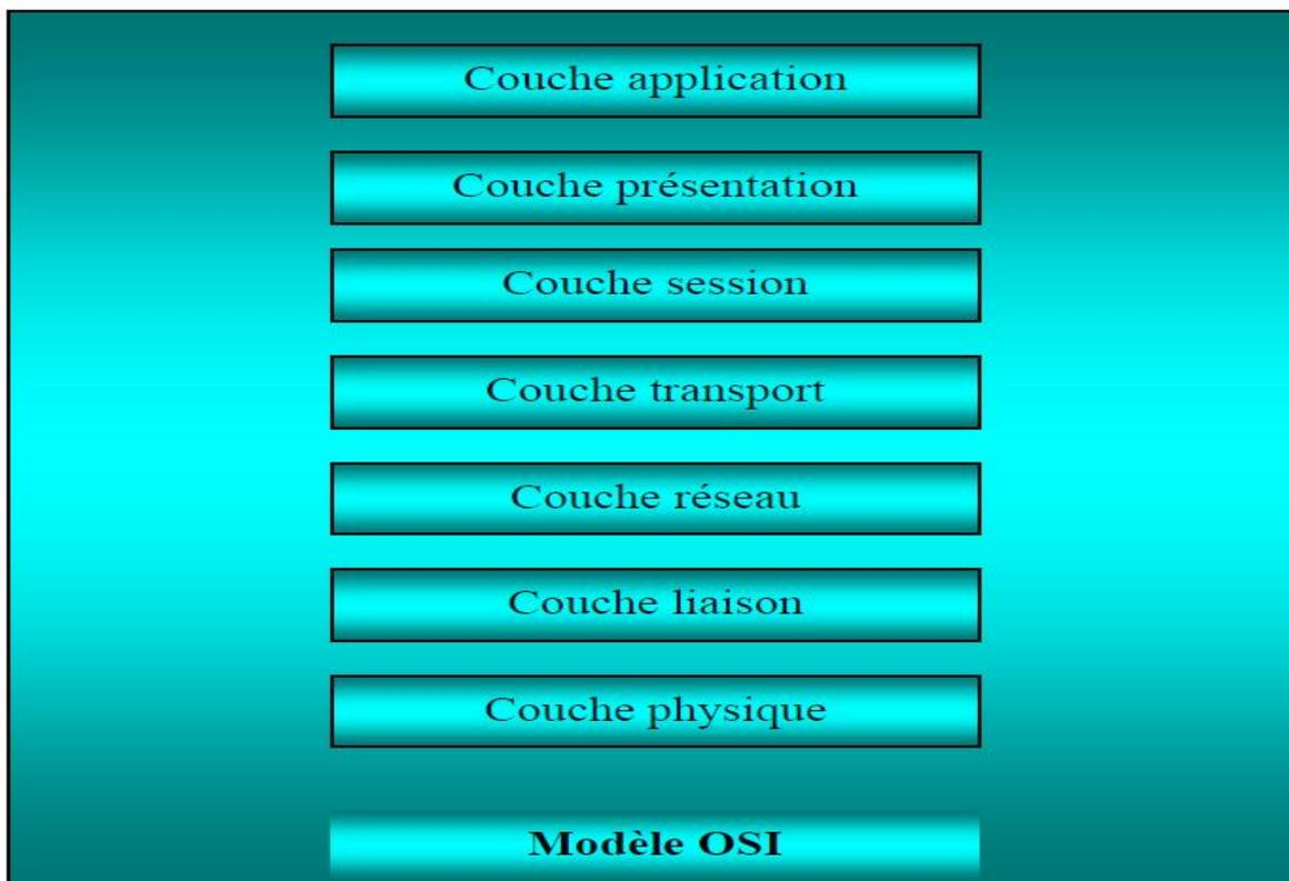
**Figure 02:** *Les couches du modèle OSI.*
