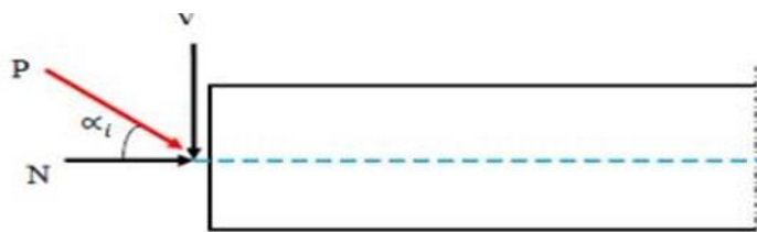
Figure VIII.5. Composante de la force précontrainte.
