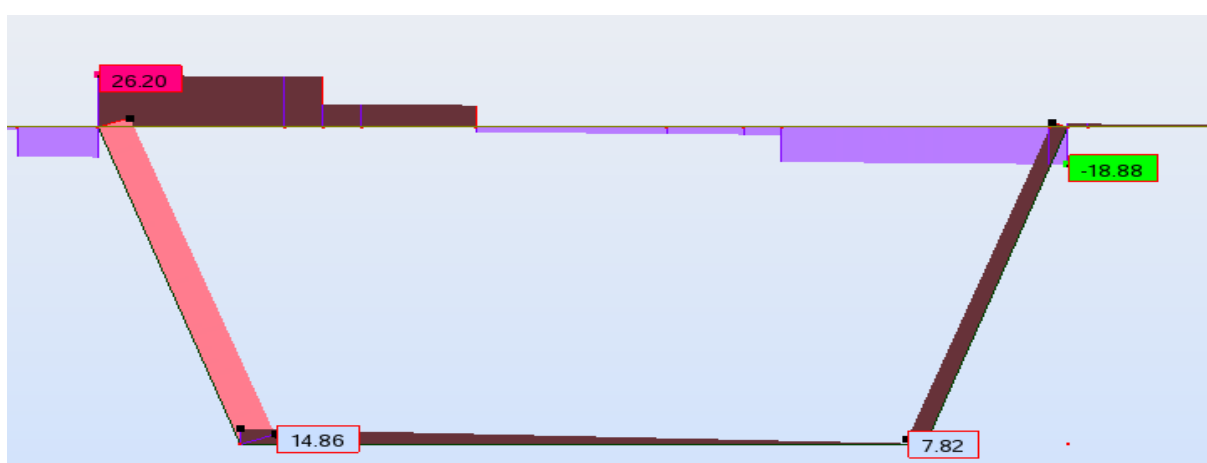
Diagramme de l'effort tranchant du voussoir sur pile (VSP) sous : 1,35G + 1,6 (B t + Q t ) à l'ELU
