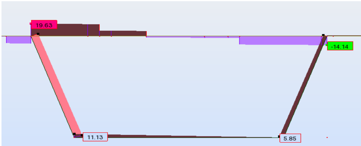
Diagramme de l'effort tranchant du voussoir sur pile (VSP) sous : G + 1,2 (B_t + Q_t) à l'ELS
