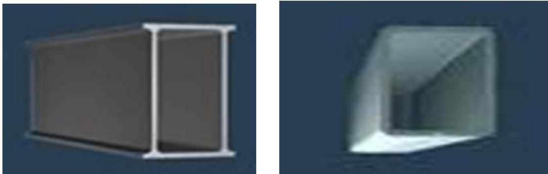
Fig105 Les poutres creuses
