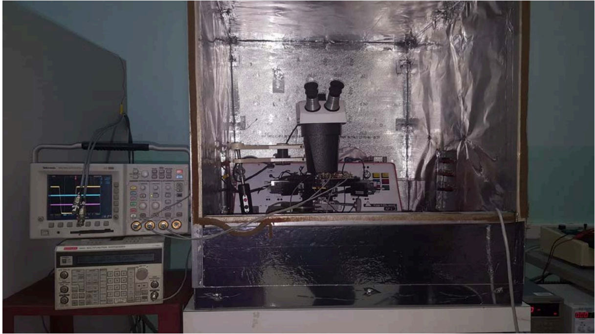
Figure III.20 : photographie de testeur sous pointes
