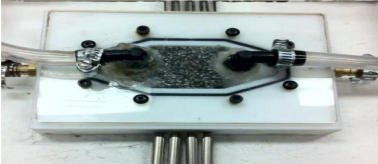
Figure I. 3: Refroidissement du processeur Intel Core i7 par la mousse d'aluminium [21].
