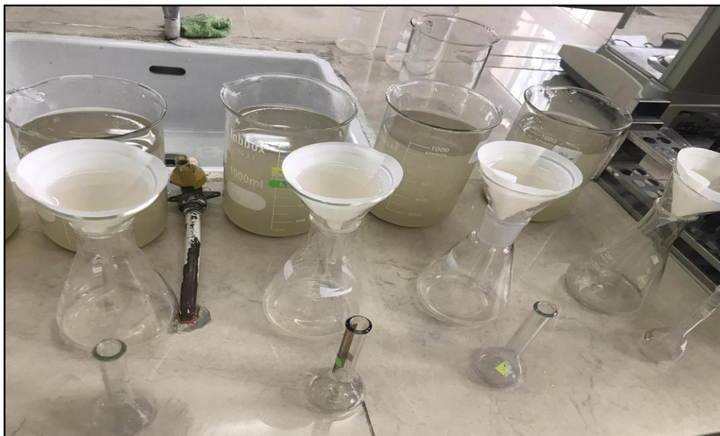
Figure 4 : Séparation solide-liquide par filtration
