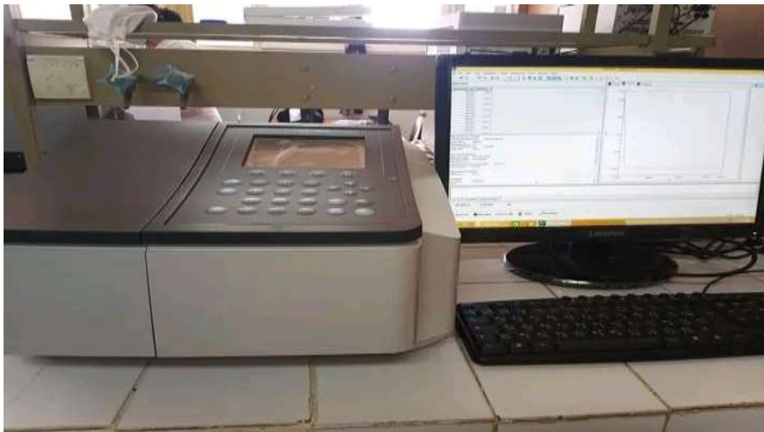
Figure II.4 : Spectrophotomètre UV-1800 à double faisceau
