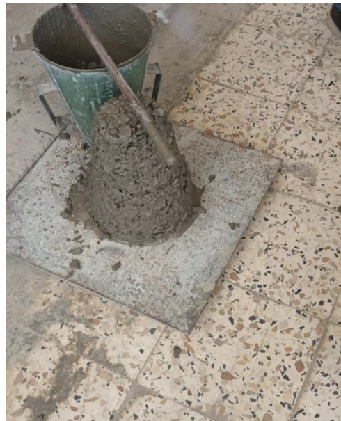
Figure II.21: Détermination d'affaissement du béton à l'état frais.
