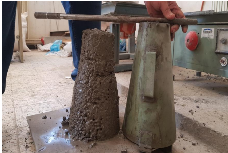
Figure III.5 : Détermination d'affaissement du béton l'état frais.
