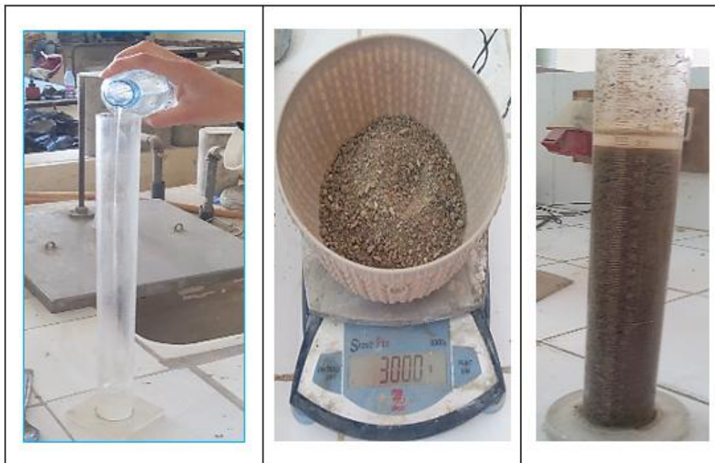
Figure II.16: Élaboration de masse volumique absolue de sable.
