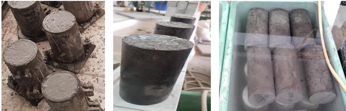
Figure II.22: Éprouvettes après démoulage et mise en cure d'hydratation
