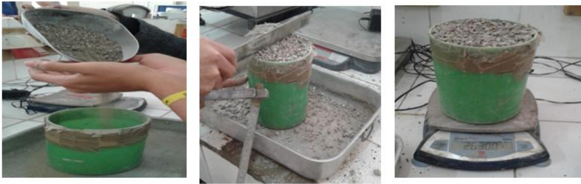
Figure II .15: Essai de la masse volumique apparente.
