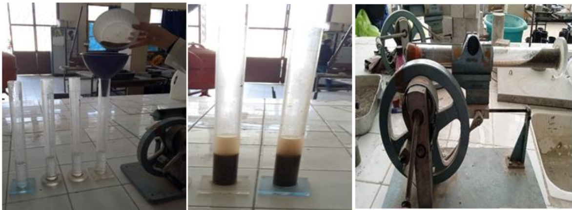
Figure II.11: Essai d'équivalent du sable.
