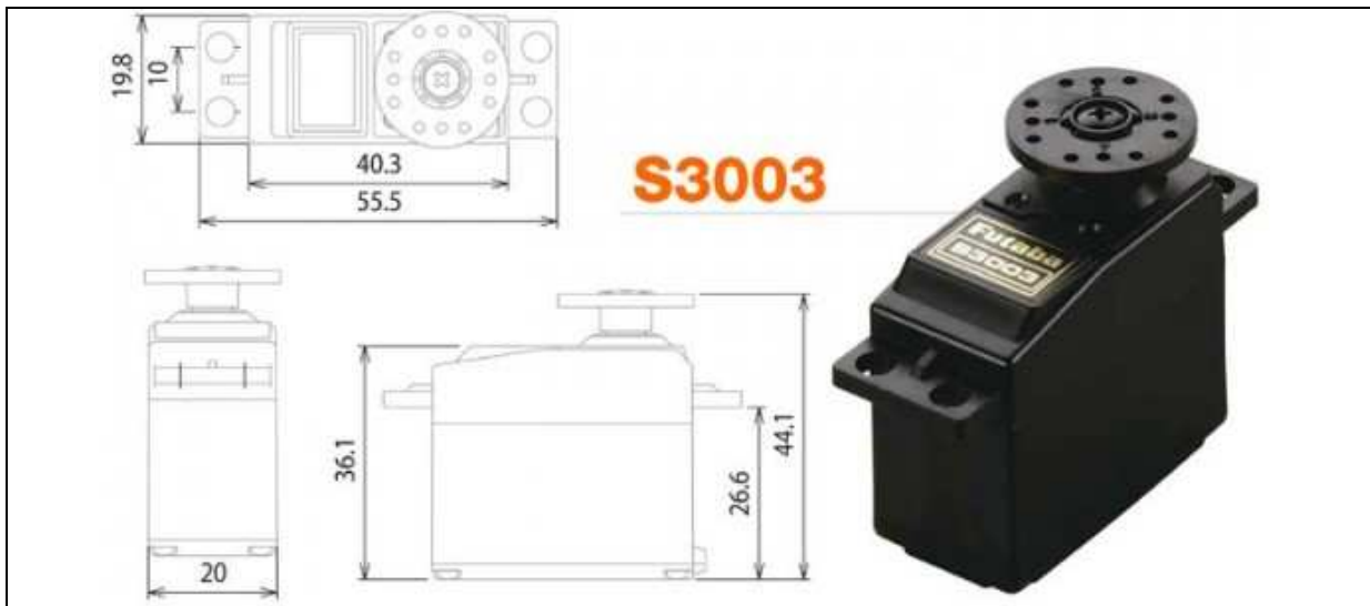
Figure n°25: Les démentions du servomoteur Futaba S3003 [6].
