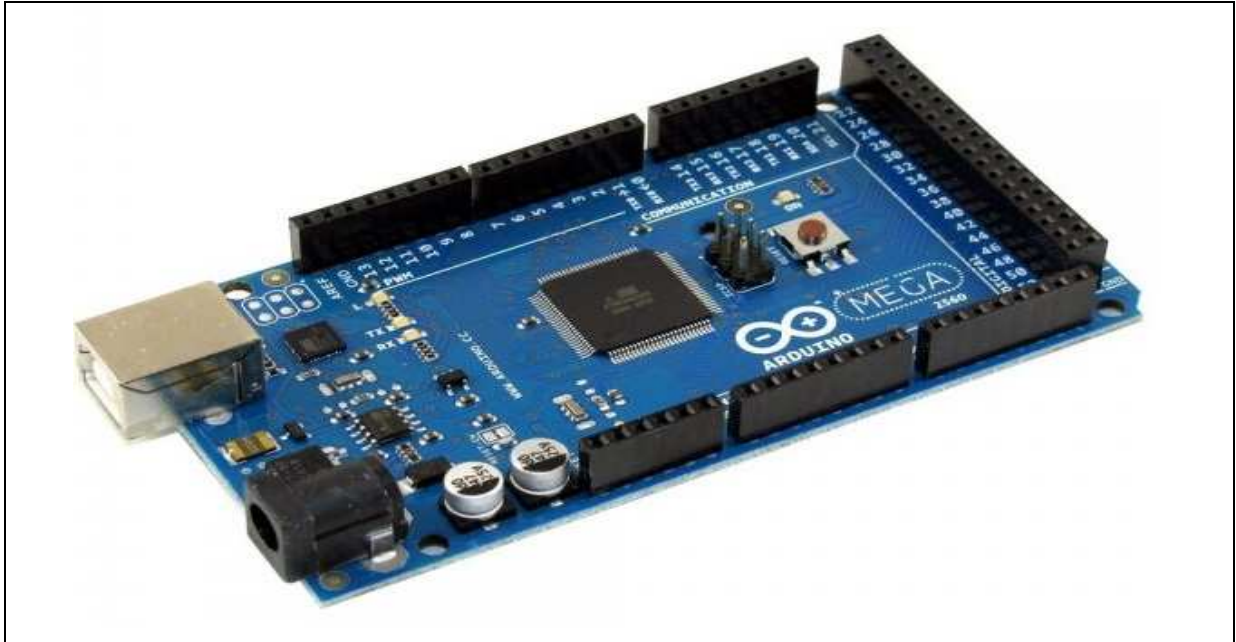
Figure n°58: carte de commande Aduino Mega 2560.
