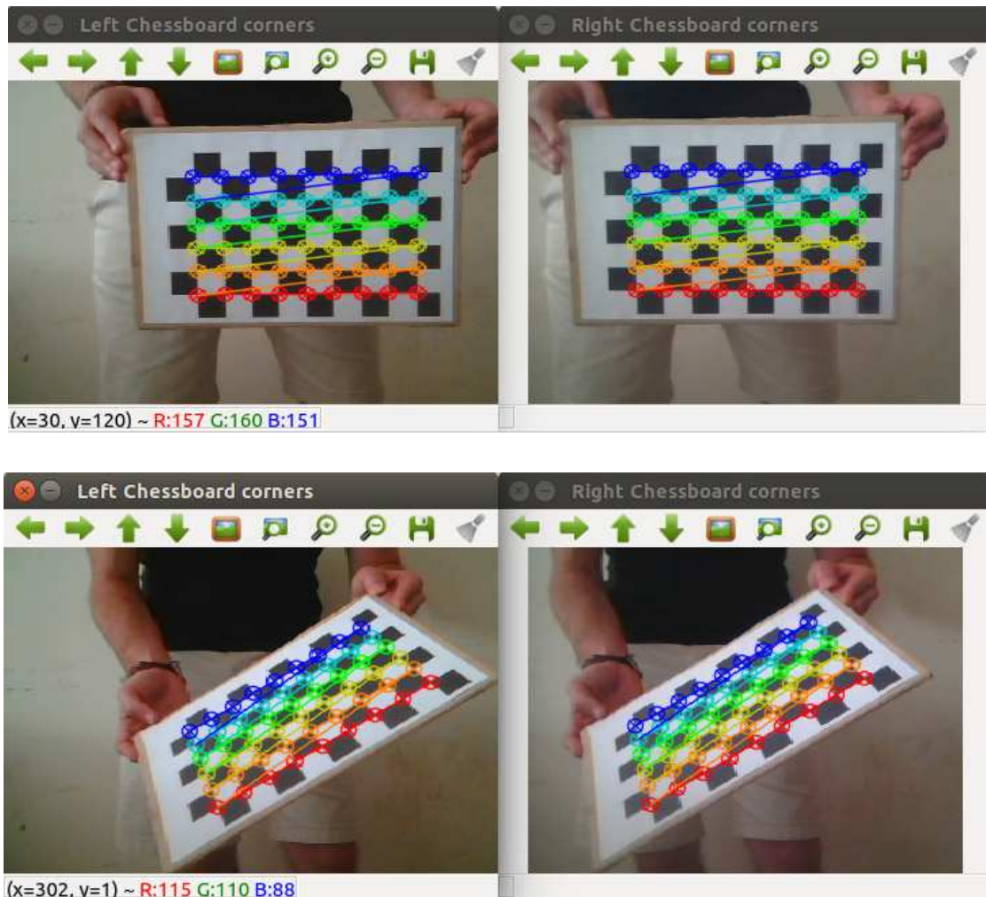
Figure n°50: Détection de coins du damier.
