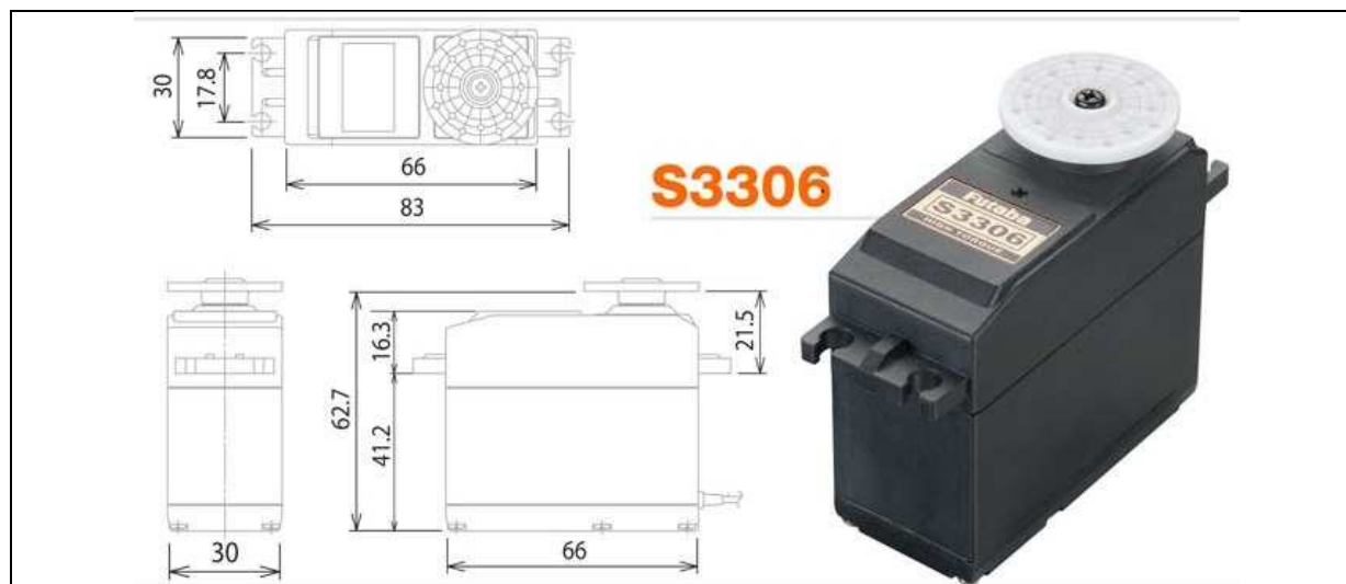
Figure n°26: dimensions du servomoteur Futaba S3306 [7].
