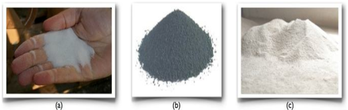
Figure II.12. Exemples de charges utilisées dans les CMO : (a) micro-billes de verre, (b) noir de carbone, (c) silice.
