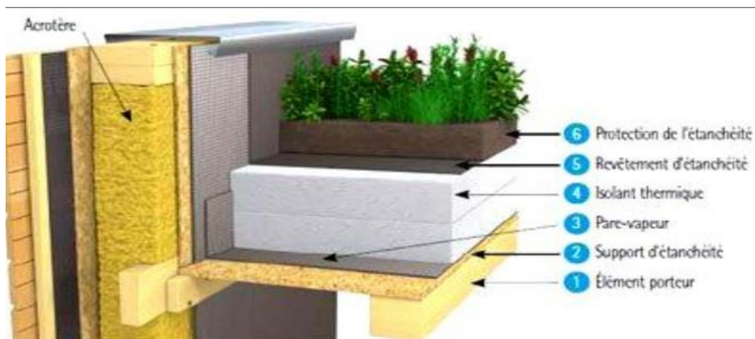
Figure 140 : Terrasse végétalisée. Source : Les techniques de structure en bois.pdf
