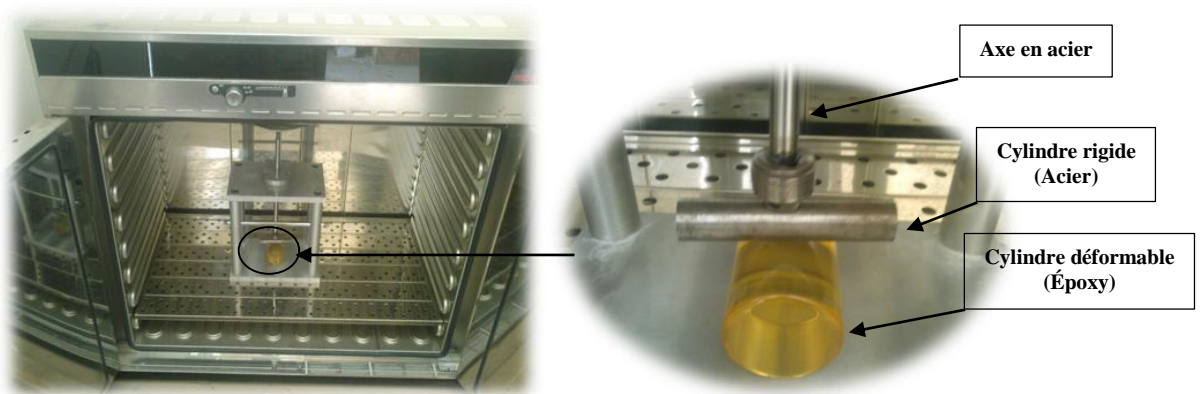
Figure IV.9: le dispositif de deux cylindres orthogonaux dans l'étuve.
