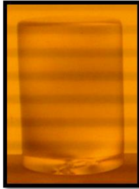
Figure IV.5 : Visualisation du modèle sous le polariscope après élimination des contraintes résiduelles
