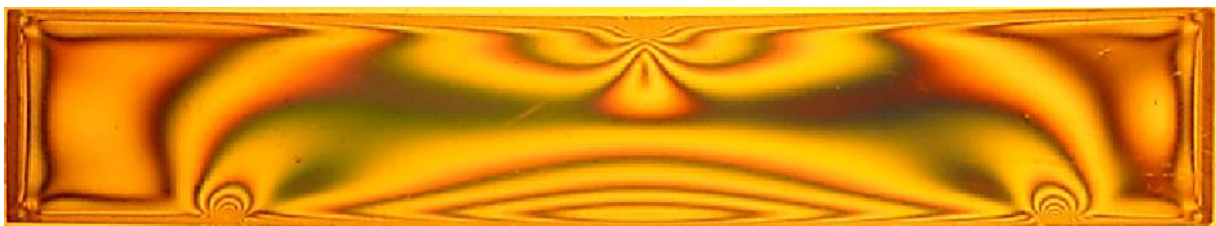
Figure III.10 : Visualisation des contraintes figées sur le modèle en champ clair
