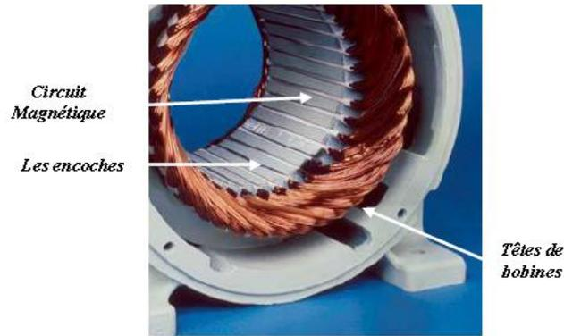
**Fig. 3.1 :** Stator de la machine asynchrone triphasée à cage.
