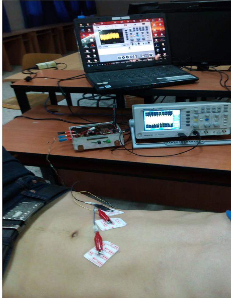
FIG. 2.12: Système réel développé pour l'acquisition des signaux EGG
