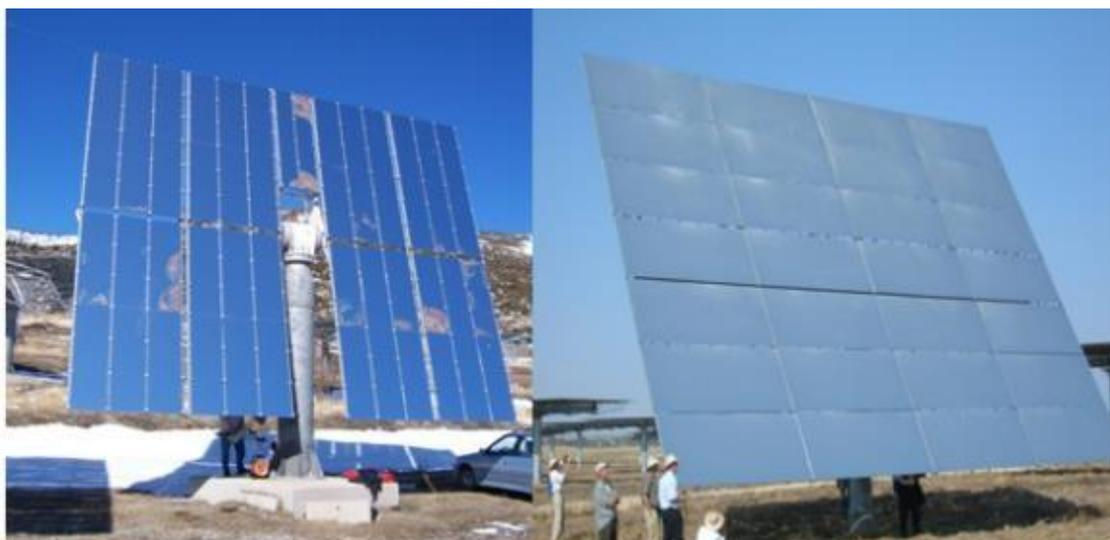
**Figure II.11 :** L'héliostat
