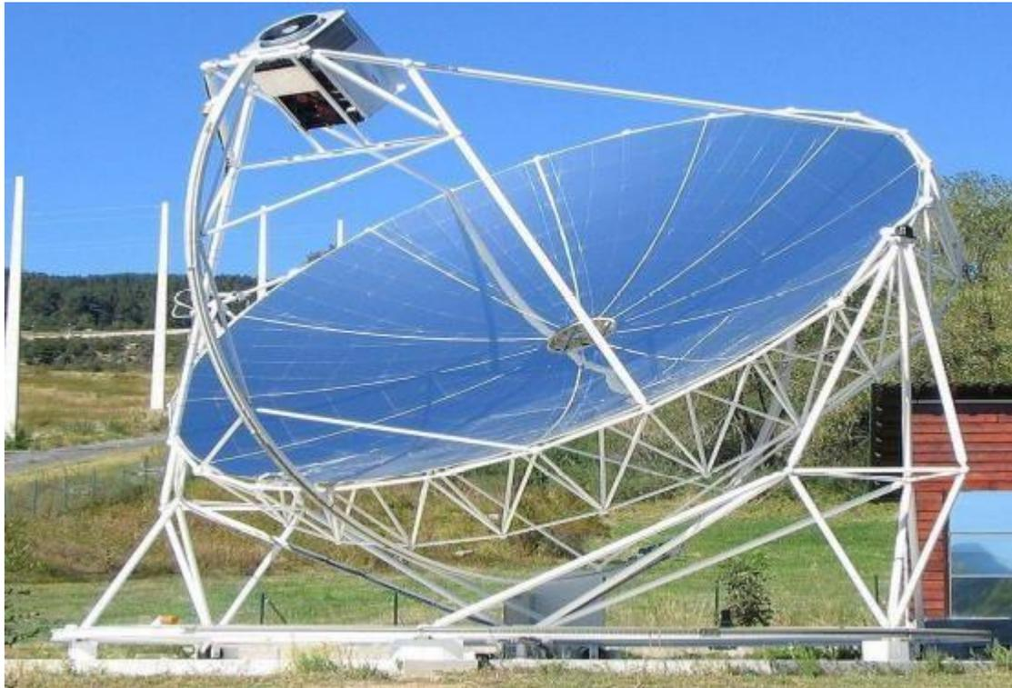
**Figure II.8:** Le concentrateur parabolique
