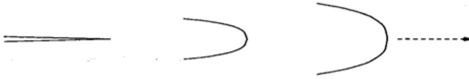
Figure II. 3 : représentation schématique de l'évolution du fond de fissure dans le cas d'une propagation droite. Etat initial, ouverture avant amorçage et ouverture en cours de propagation [2]
