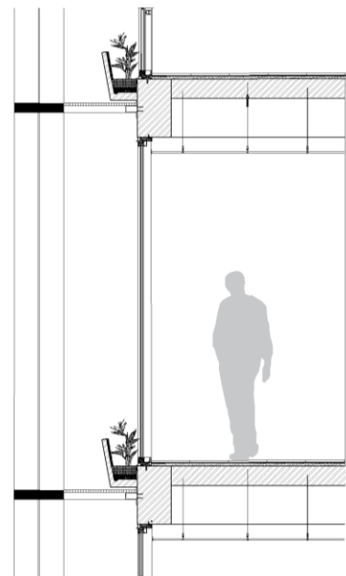
Figure 182: Coupe sur la façade ventilée du projet Source : Auteurs
