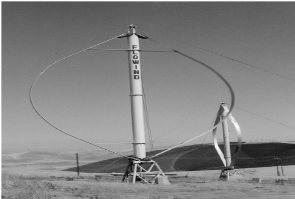
Figure 6.I : éolienne Darrieus du constructeur américain Flowind d'un diamètre de la turbine de 19 m et une puissance de 170 kW [08]
