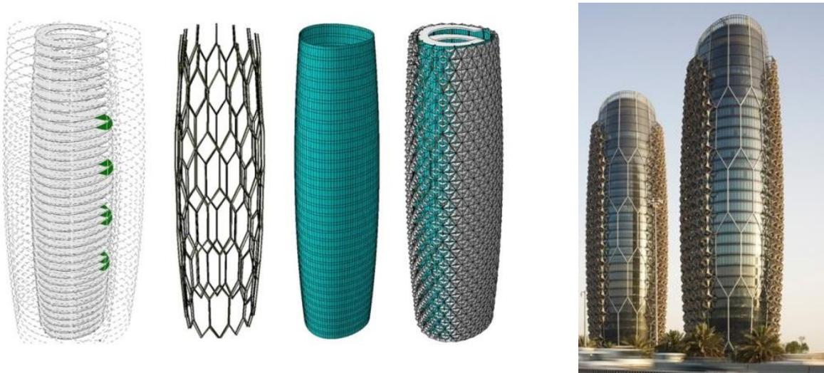
**Figure 183 :** la stucture de l'enveloppe adaptative de tours Al-Bahar
