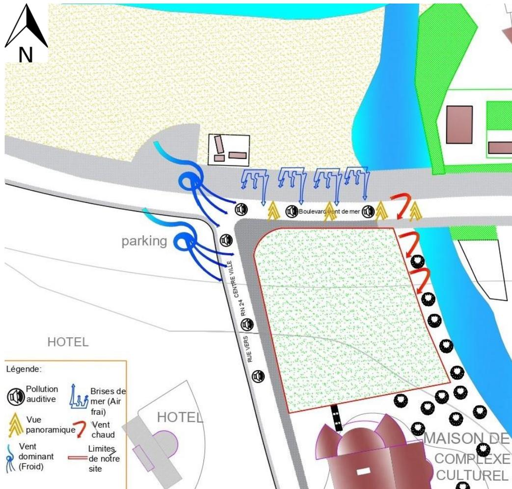
Figure 60 : schéma qui resume les données micro-climatique de site ;source :auteurs
