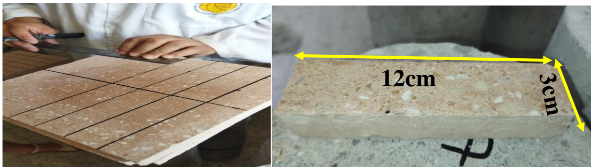
Figure 39: Éprouvettes pour l'essai de flexion.
