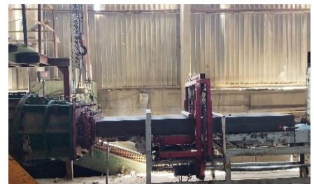
Figure 22: L'étireuse pour l'extrusion sous vide.
