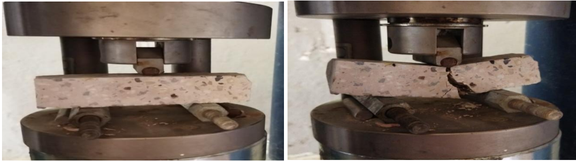
Figure 40: photos montrant la rupture de l'éprouvette sous l'effet de la force des trois points.
