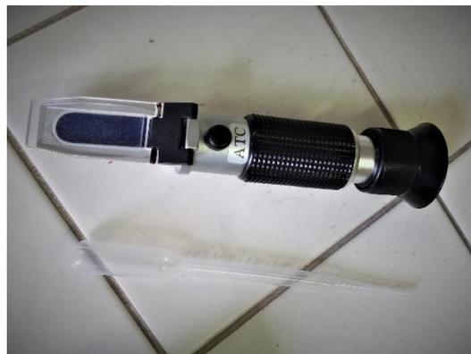
**Figure 1 Réfractomètre**
