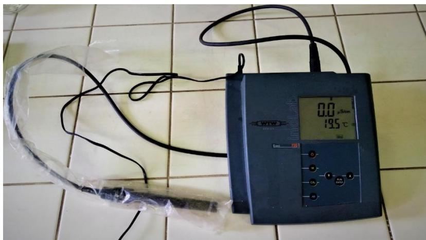
Figure 3 Conductimètre
