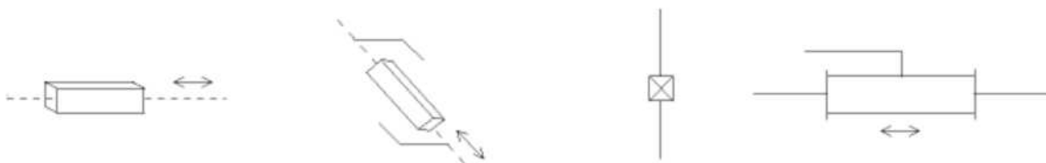
Figure : Symbole de l'articulation prismatique .
