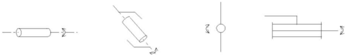
Figure : Symbole de l'articulation rotoïde .
