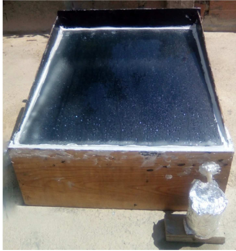
Figure IV.1 : Distillateur solaire utilisé dans l'expérience
