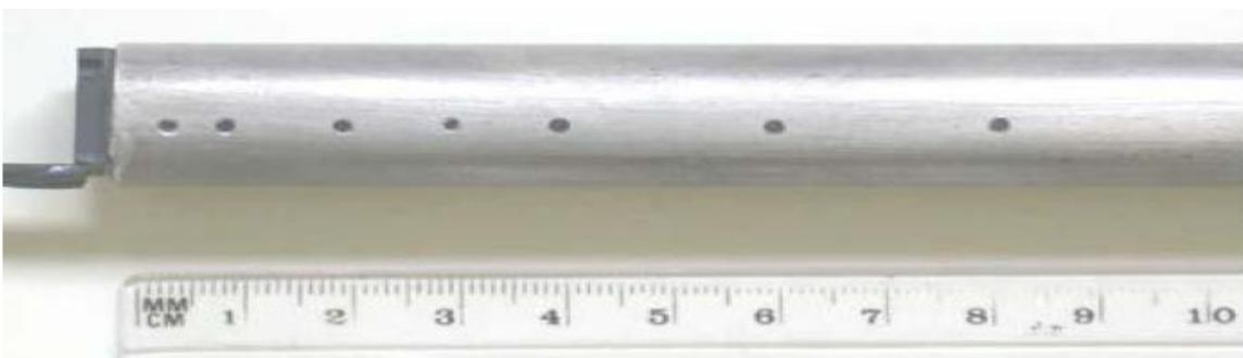
**Figure III.1** : la barre d'aluminium, résistance chauffante 0 – 12W (à gauche) et orifices de mesures.
