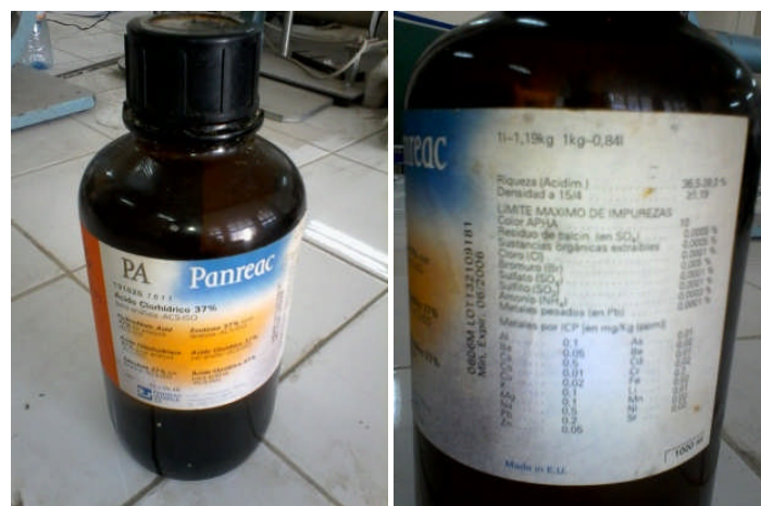
Figure V- 19: l'acide utilisé dans l'essai de durabilité
