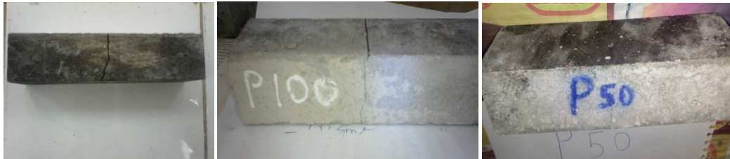
Figure V- 15: éprouvettes prismatiques après l'essai
