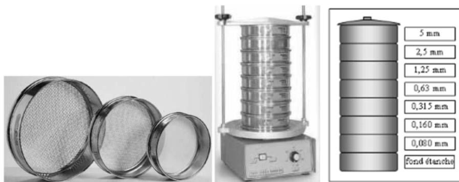
Figure IV-4: les tamis utilisés dans l'analyse granulométrique
