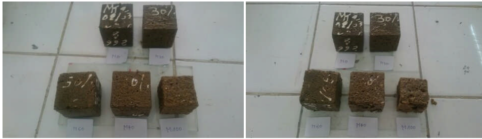
Figure V- 35: éprouvettes dégradées aux 7 ème et 14 ème jours
