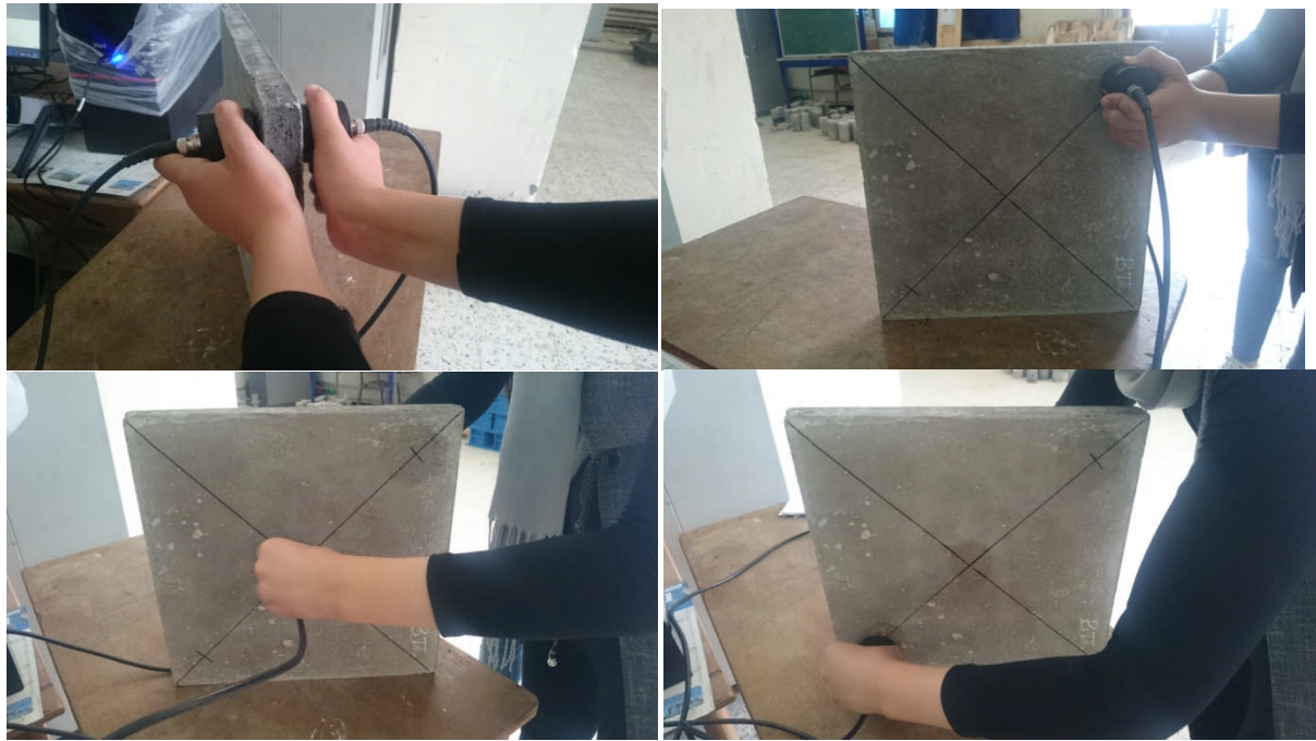
Figure V- 18 : Disposition et emplacement des transducteurs sur l'éprouvette d'essai
