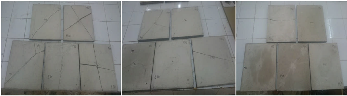
Figure V-17 : dalles après l'essai poinçonnement à 14, 28 et 56 jours (de gauche à droite)
