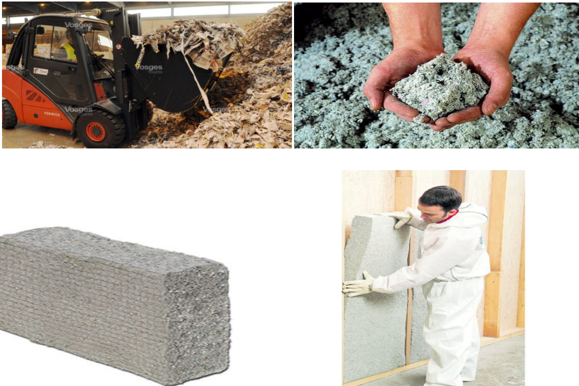
Figure III- 7: La ouate de cellulose (meilleur isolant thermique) obtenue par recyclage
