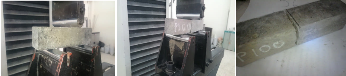
Figure V- 14: Eprouvette avant, pendant et après l'essai de flexion trois points
