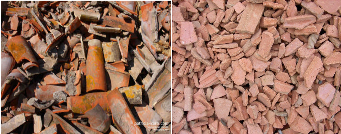
Figure III-3: déchets de brique en terre cuite à recycler
