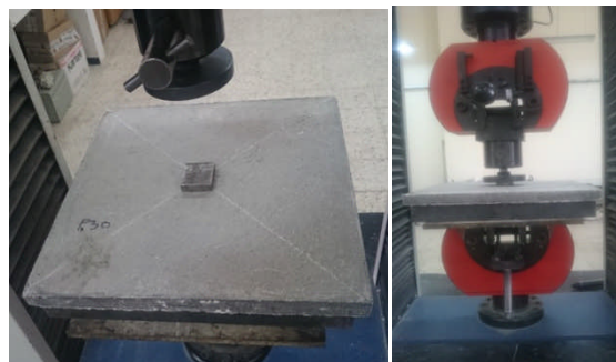
Figure V- 16: Une éprouvette soumise à l'essai de poinçonnement
