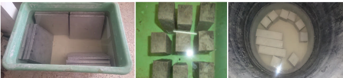
Figure V- 5 : la conservation des éprouvettes dans l'eau
