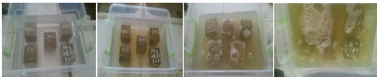
Figure V- 34 : Dégradation d'éprouvettes dans le milieu acide
