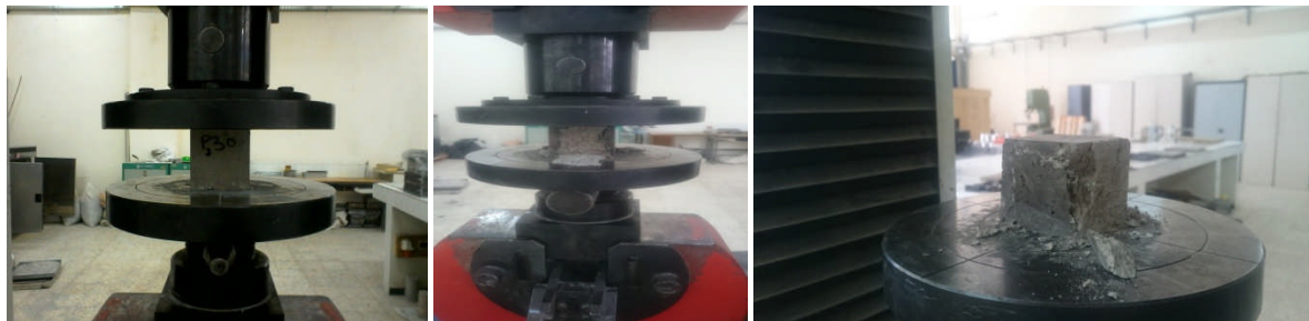
Figure V- 12 : Une éprouvette avant, pendant et après la compression
