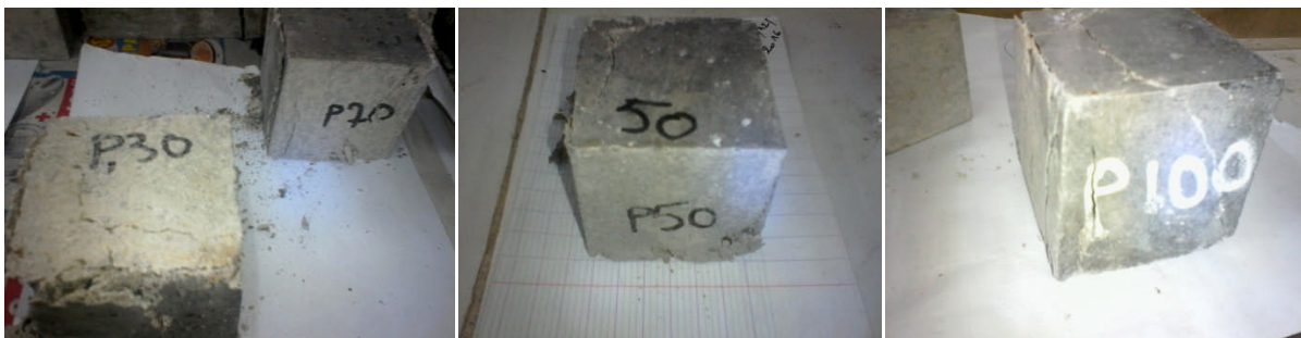
Figure V- 13 : éprouvettes cubiques après l'écrasement
