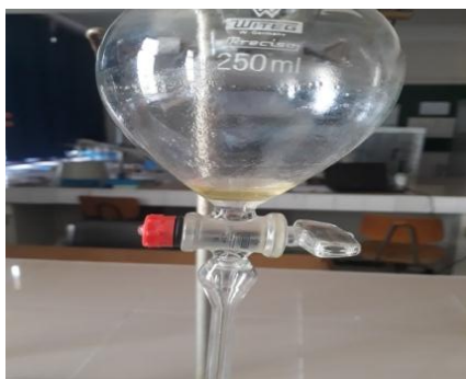
Figure 29 : Un décanteur (originale,2019)
