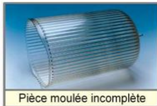
Figure 26 : pièce moulée incomplète
