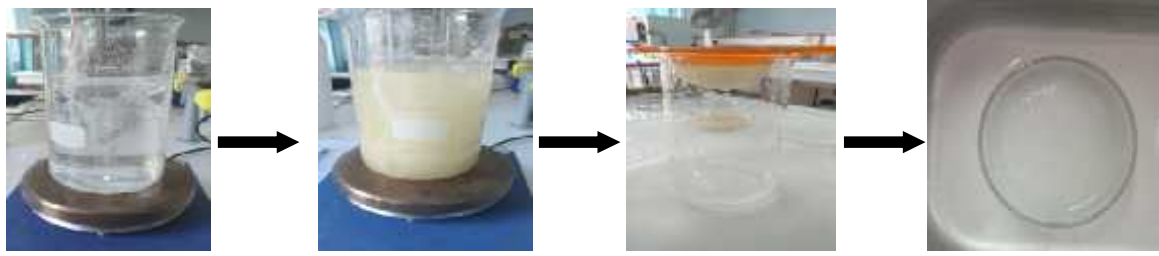
a) Solution de NaOH b) Solution de NaOH avec la laine c) Filtration d) Gel de kératine
