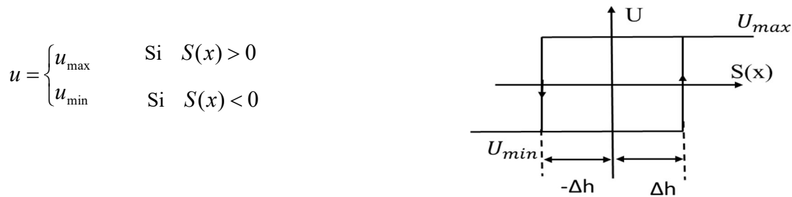
Figure II.9. Caractéristique de commutation
