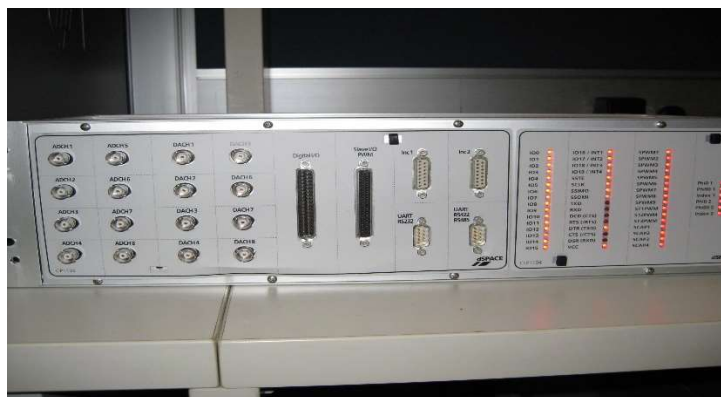
Figure IV.5. Panneau de contrôle DSpace1104
