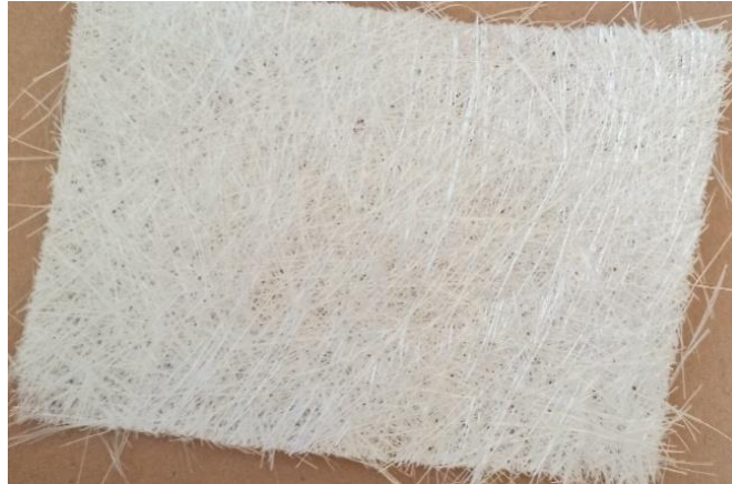
Figure III.4 : Les files de verre (mat 600)
