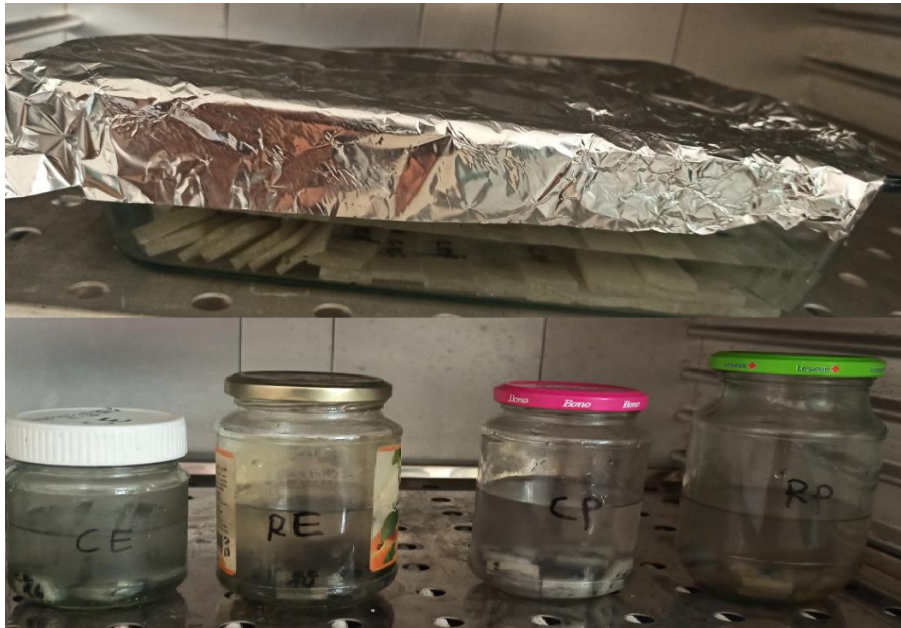
Figure III.13 Eprouvettes dans l'eau distillée, dans l'étuve
