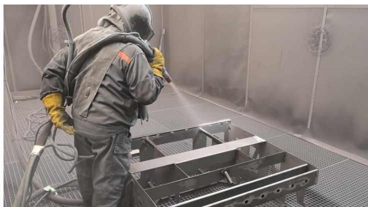
Figure IV.21 : Procédé de grenailage.
