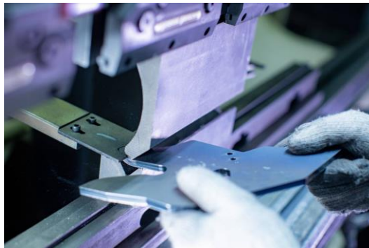
Figure IV.9 : Pliage en l'air [20].
