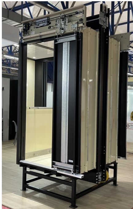
Figure IV.1 : Montage de la cabine et de l'arcade.
