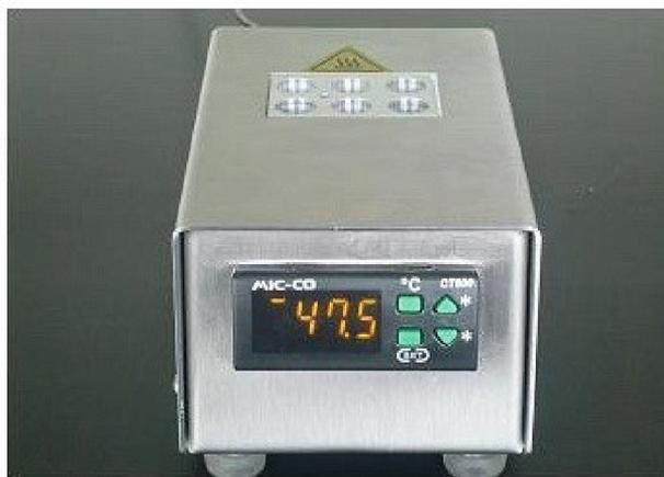
Figure 10: incubateur à test rapide
