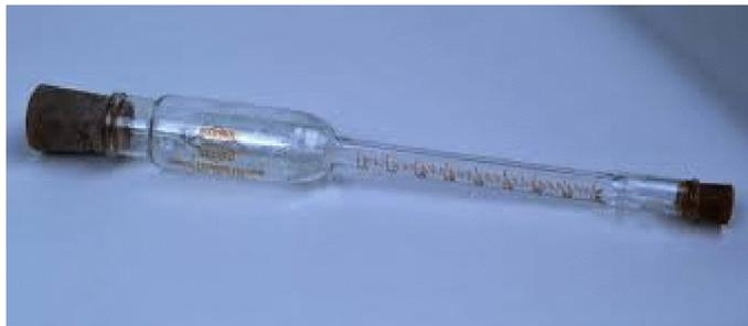
Figure 4 : butyromètre à fromage GERBER
