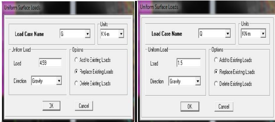
Fig V.17 : Chargement du plancher
