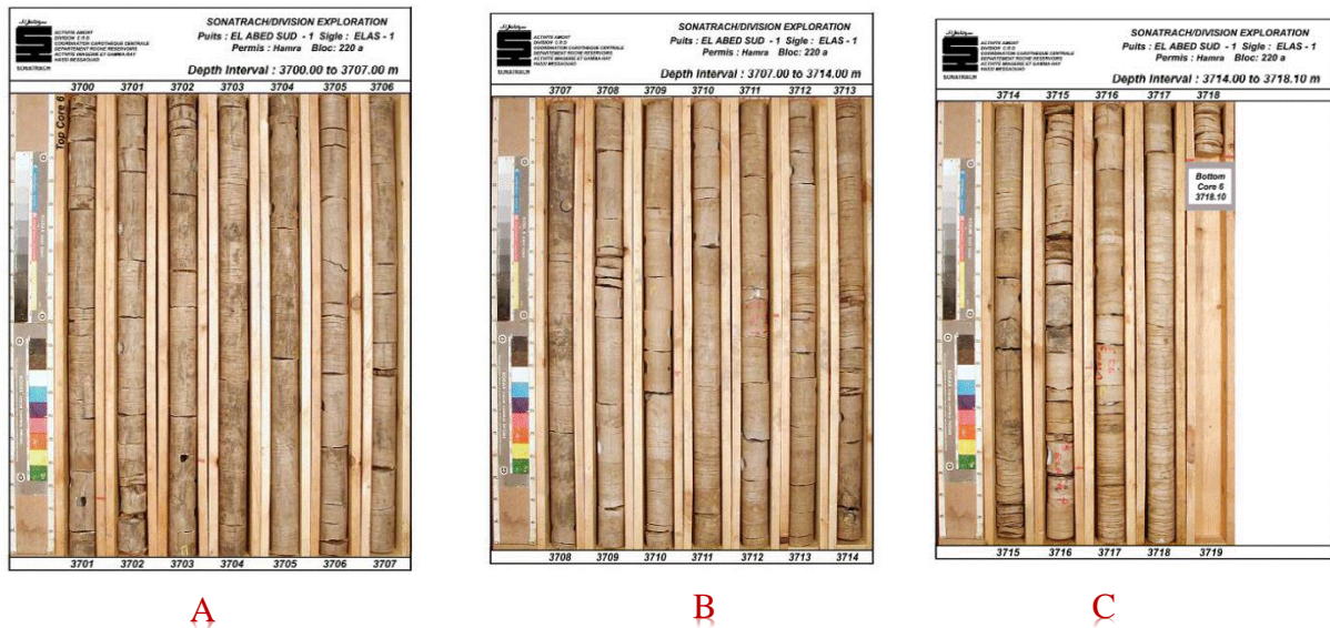
Figure 66. Échantillons carotte n° 6 prélevés du puits « E-1 » en face de l'Ordovicien (Documents SONATRACH.2011).
