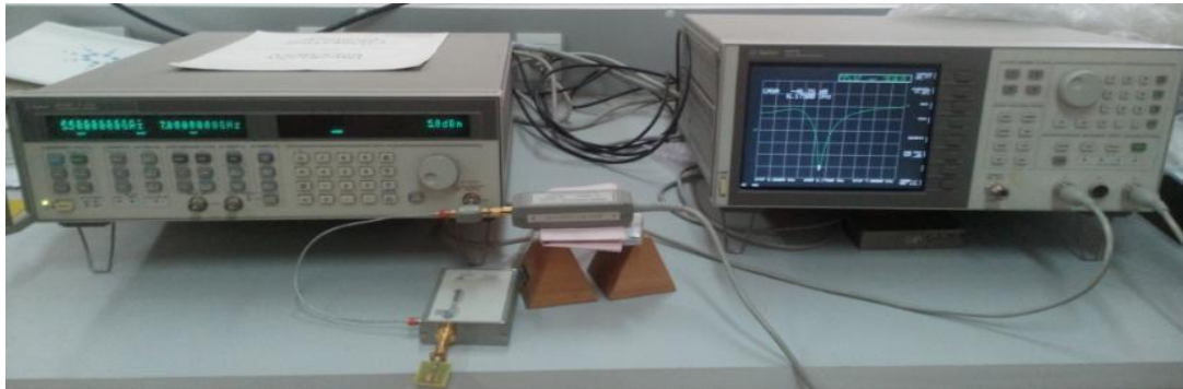
Figure III.1 Analyseur de réseau scalaire du laboratoire d'antennes
