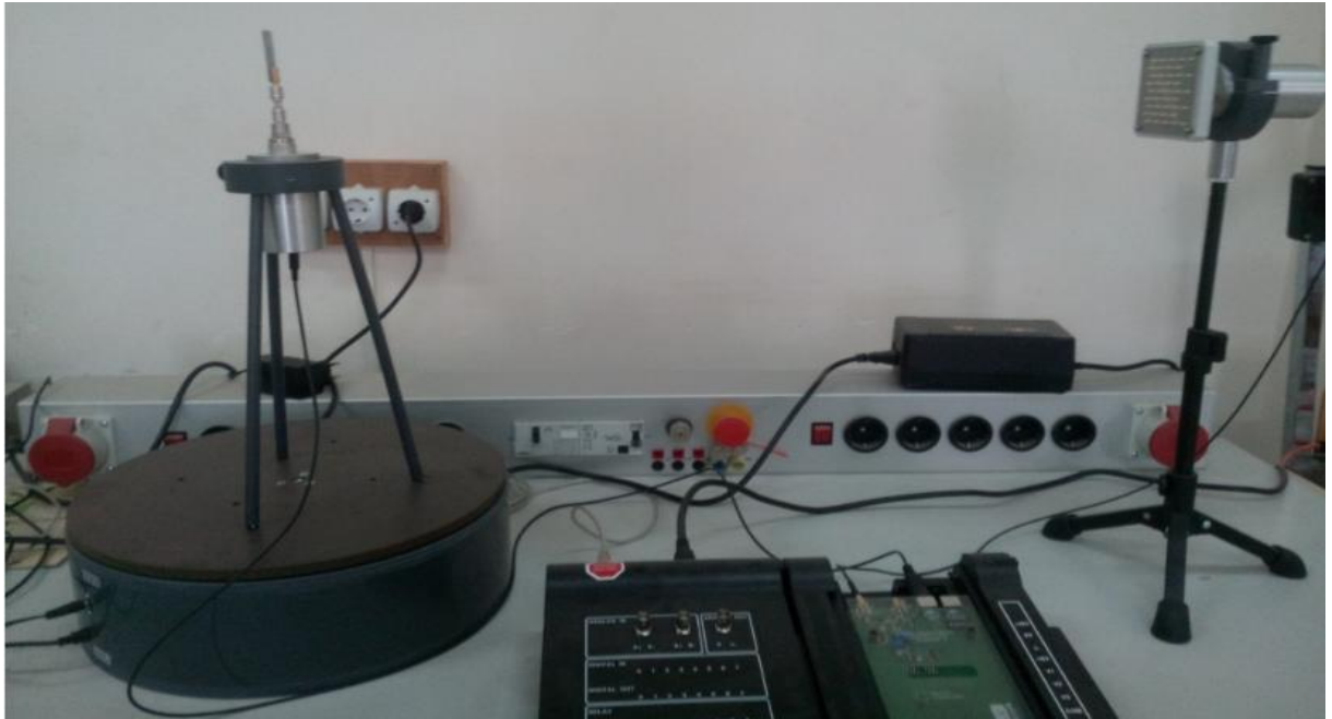
Figure III.22 Montage pour la mesure du diagramme de rayonnement de l'antenne Patch à polarisation linéaire.
