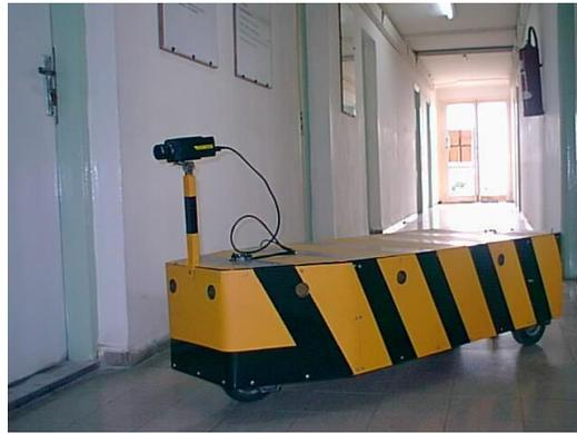
Figure 4.11 Image robot avec caméra embarquée le long du couloir pendant la préparation.
