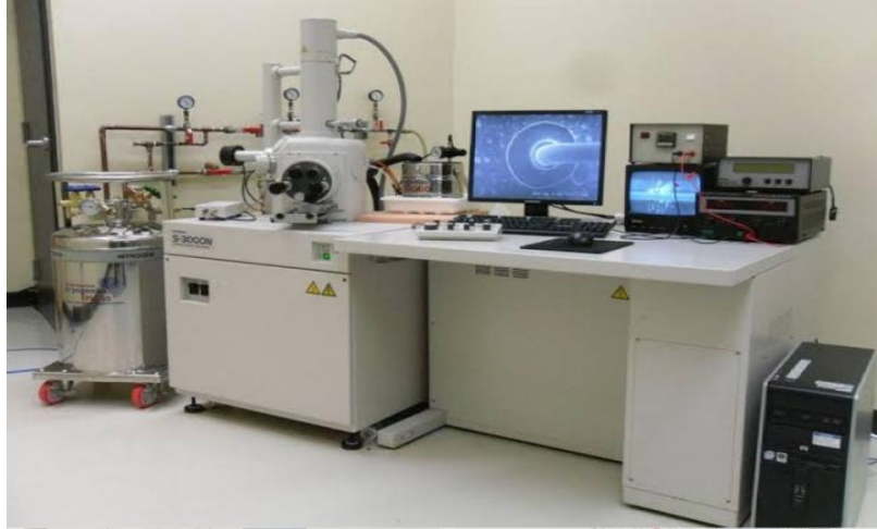
Figure 17: MEB ESEM XL 30 Philips à filament de tungstène.
