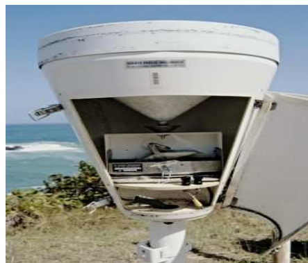
Figure II.2.a : détail du mécanisme des augets
