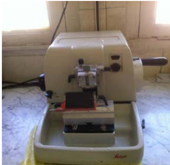
Figure 28: Dispositif permettant de faire des coupes : microtome (Mabed et Madoun.2021)
