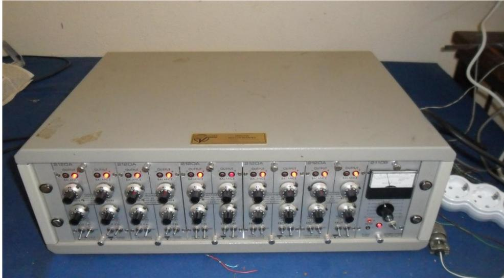
**Figure V.13 :** Chaîne d'acquisition « MICROMESURE VISHAY »
