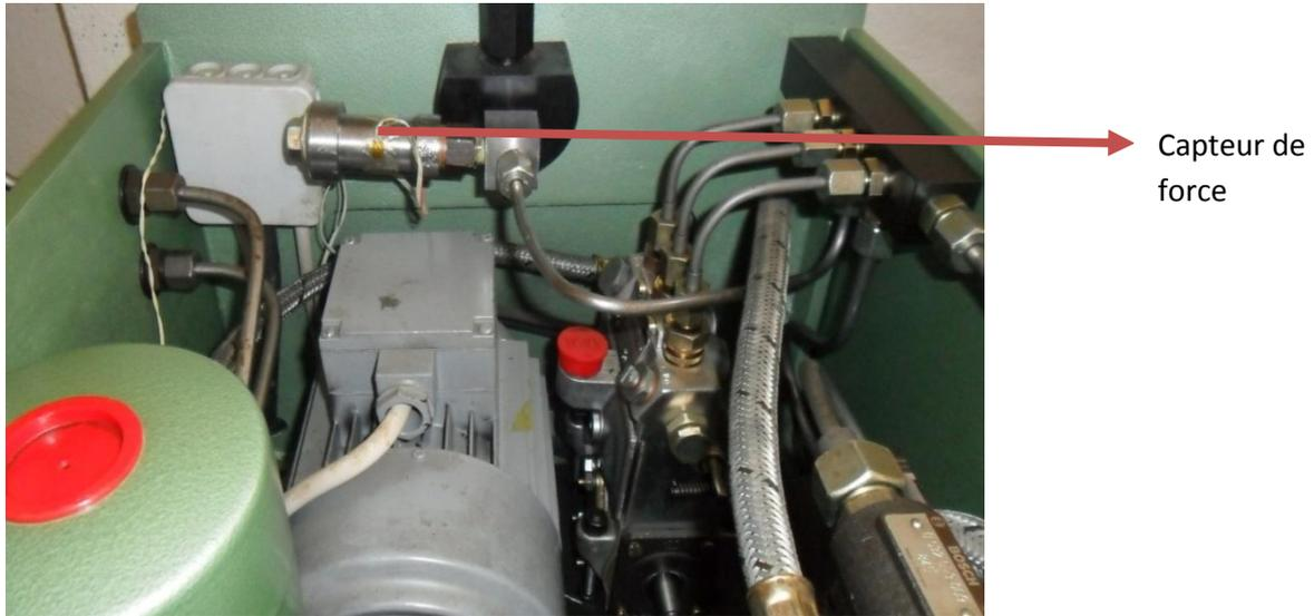
**Figure V.11 :** Montage du capteur de force sur la canalisation hydraulique de la machine de traction.
