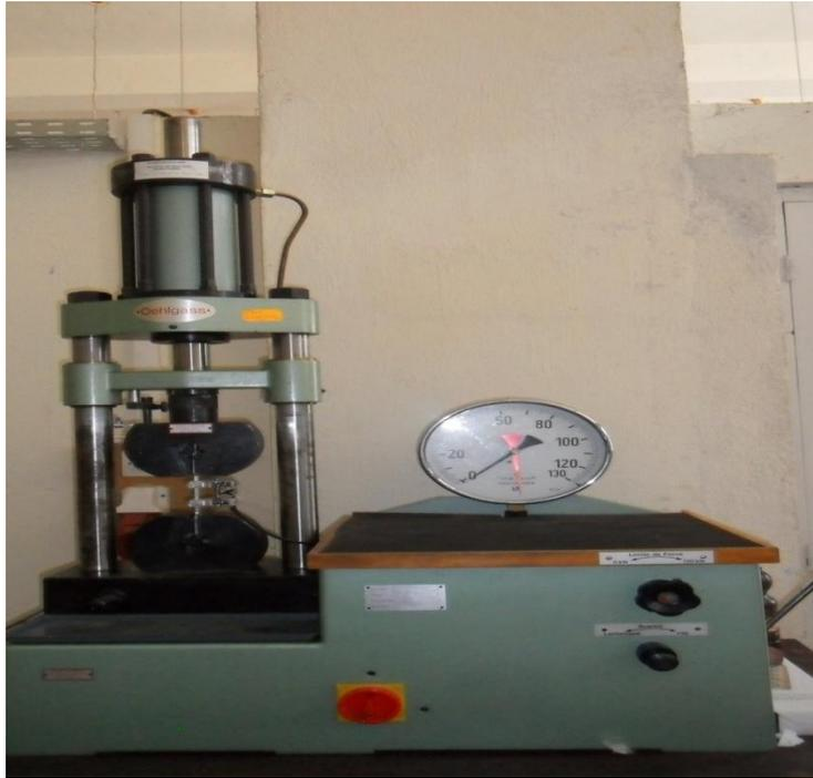
**Figure V.21** : Machine de traction «OEHLGLASS»
