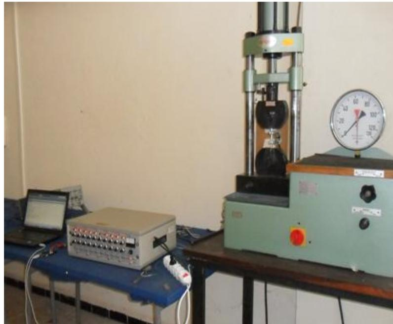
**Figure V.24 :** Le montage du capteur sur la machine de traction
