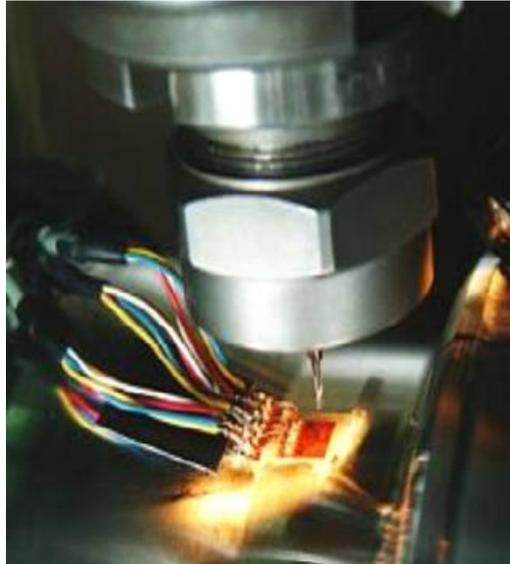
*Figure III.9* : Perçage de la jauge de contraintes résiduelles
