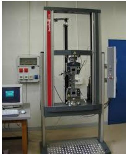
**Figure IV.3 :** machine de traction avec acquisition de données
