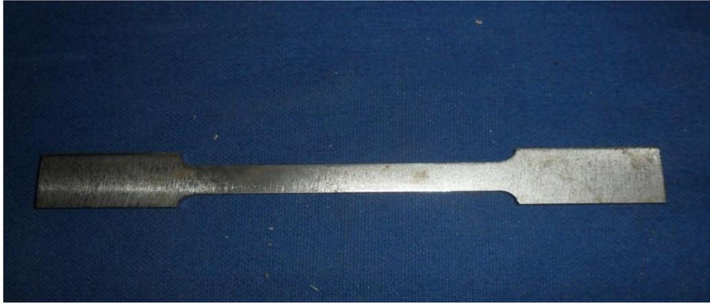
**Figure V.18** : Éprouvette plate
