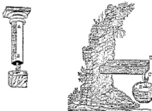
**Figure 1.1** : Dessins de Galilée pour illustrer l’essai de traction et l’essai de flexion [1]
