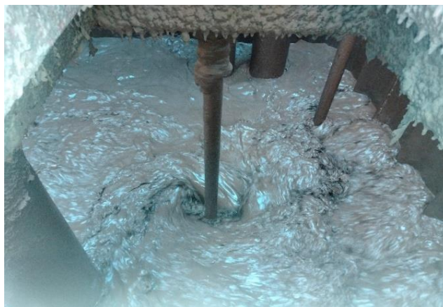
Figure I.8 : Bac à boue.
