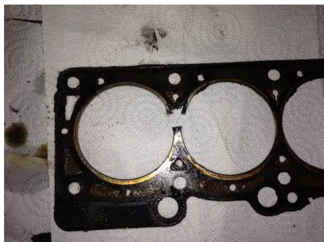
Figure V.7 : Joint de culasse défectueux [1].
