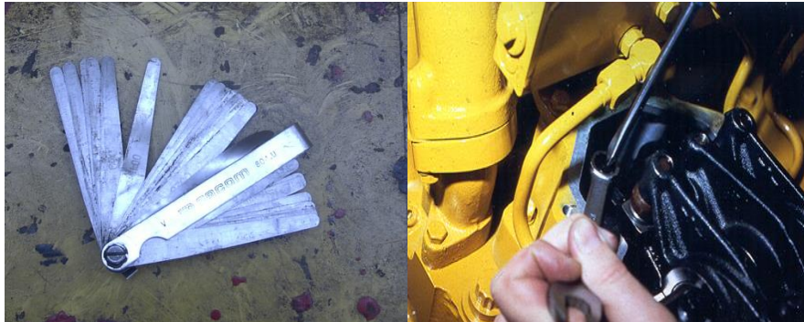
Figure V.2 : réglage de jeu et les cales [1].
