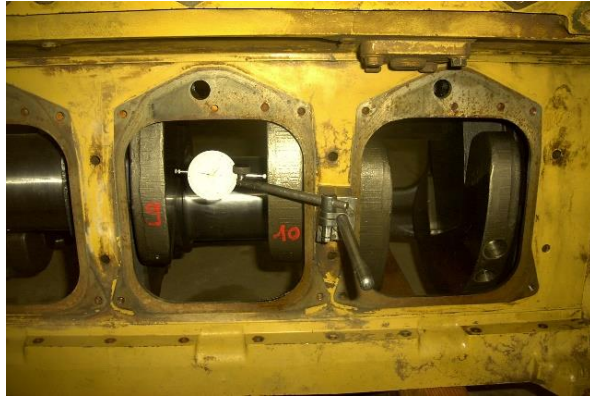
Figure V.4 : Mesure le jeu de palier [1].
