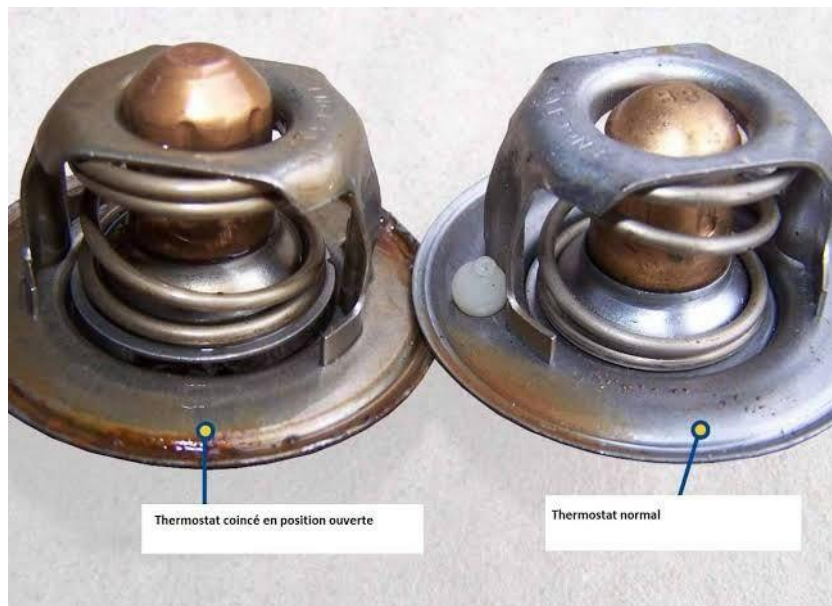
Figure V.10 : Thermostat coincé en position ouverte [1].
