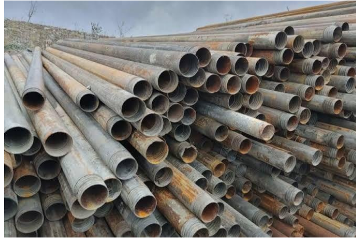
Figure I.4 : Les tiges de forage [2].
