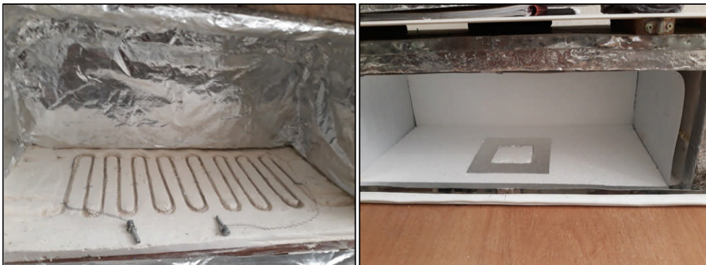
Fig 4.11 : Installation de l'isolation thermique des deux compartiments : le chaud (à gauche de l'image) et le froid (à droite).
