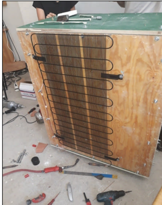
Fig 4.6 : Installation du condenseur sur la face arrière de la boîte
