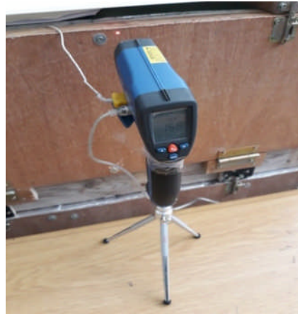
Fig 5.5 : Pyromètre utilisé pour les mesures de température en continu grâce à la détection par infrarouge et thermocouple K.
