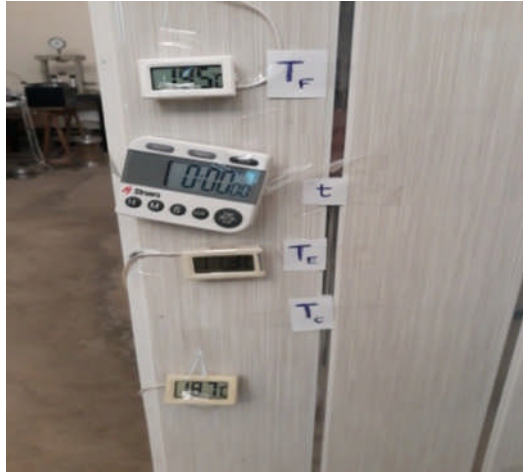
Fig. 5.9 : afficheurs des thermocouples placés dans les différentes zones concernées. La température de la salle (ambiante) est affichée sur le pyromètre infrarouge (Fig. 5.5).
