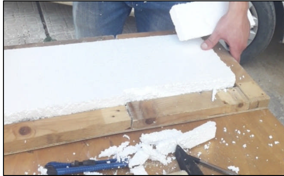
Fig 4.12 : Fabrication de la porte du compartiment froid.
