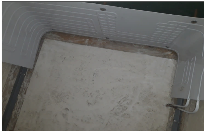
Fig 4.5 : installation de l'évaporateur
