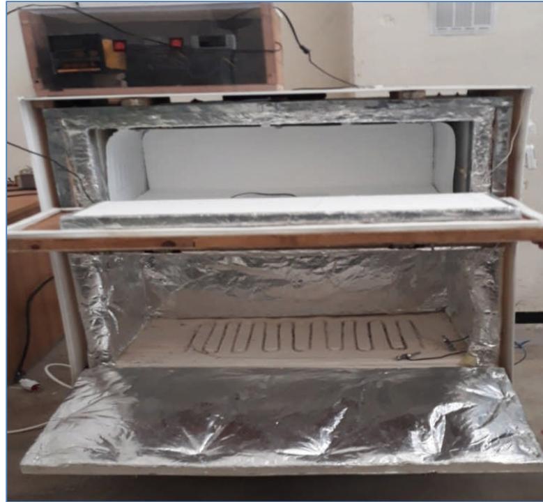
Fig. 5.1 : Dispositif de mesure de la conductivité thermique
