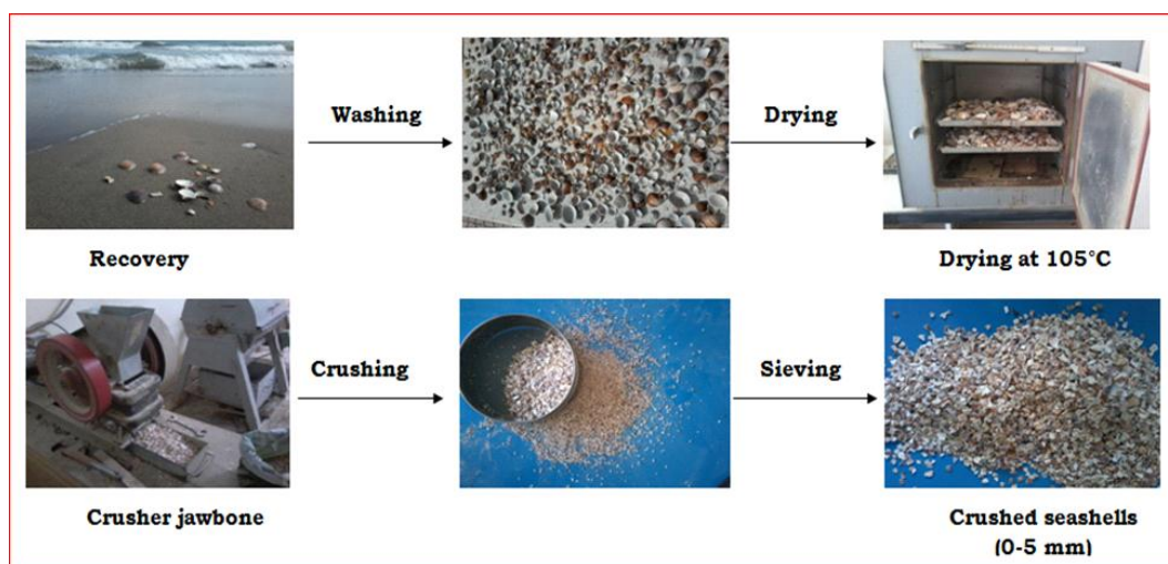
Figure IV.5: Étapes de préparation des coquillages écrasés
