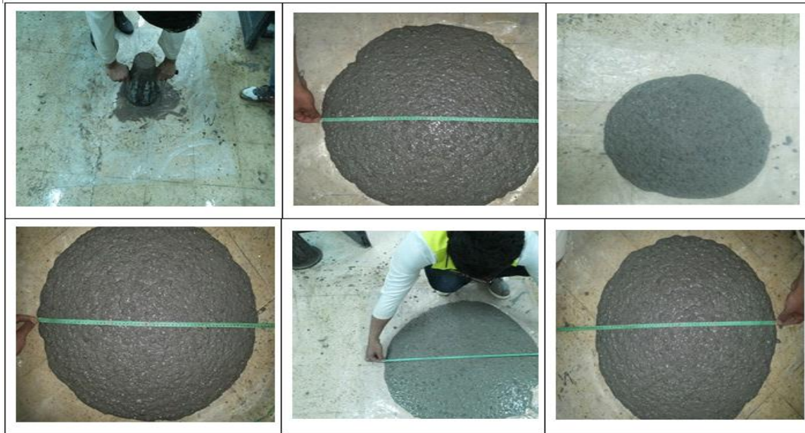
Figure IV.8 : Essai d'écoulement et la mise en œuvre du béton
